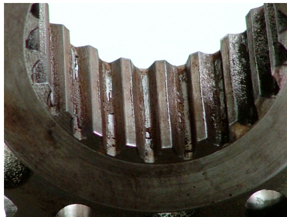
Bild 9: Ungeschmiert geprüfte Nabe
