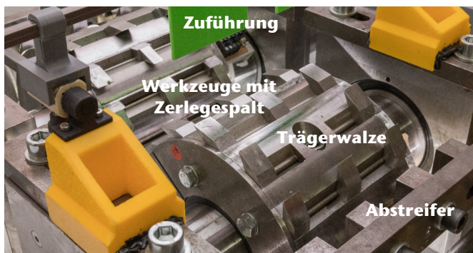
Abbildung 1: Schräge Draufsicht auf die Versuchsanlage mit voller Werkzeugbestückung und voller Schneidlänge
