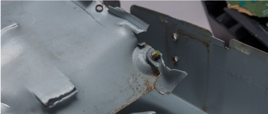
Abbildung 3: Eingriffstelle sowie Versagen der Blechhülle an intaktem Fügeelement (Schraube)
