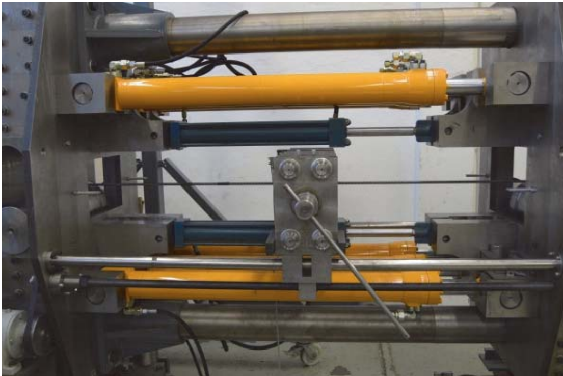
Abbildung 2: Der Querelastizitätsprüfstand mit dem Querprüfgerät /1/
