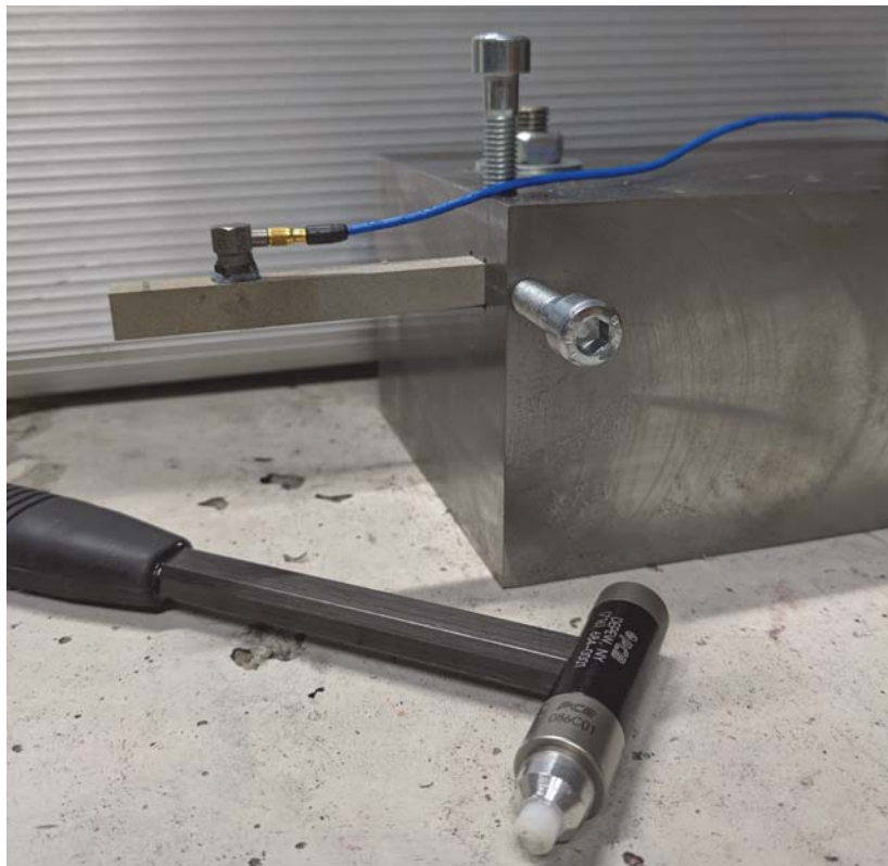
Abbildung 3: Versuchsaufbau zur Bewertung der Impedanz der Proben
