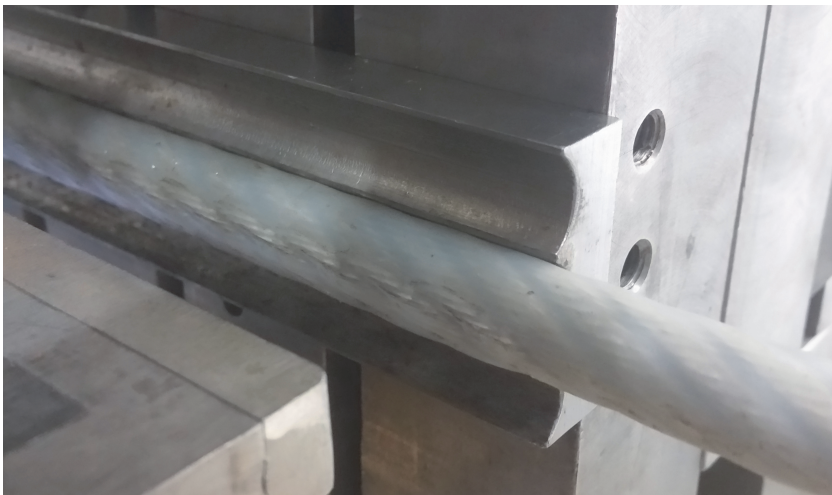
Abbildung 5: Der Kunststoff 2 wird bei den hohen Querlasten aus dem Kontakt gedrückt
