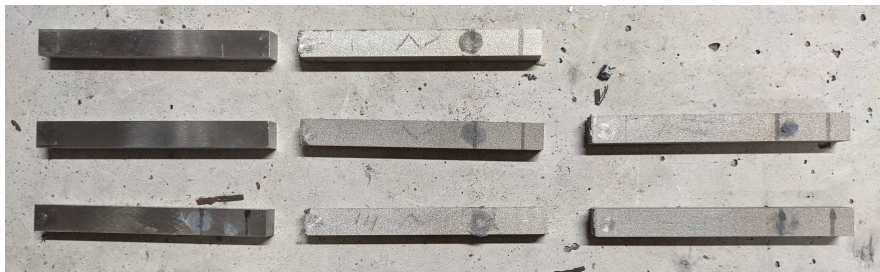
Abbildung 5: Versuchsproben (Links: gezogener Stahl; Mitte: 3D-gedruckte Probe ohne Innengeometrie; Rechts: 3D-gedruckte Probe mit Innengeometrie)
