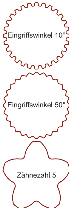
Abbildung 9: Verschiedene Geometrien – Modellierungsgrundlage der DIN 5480
