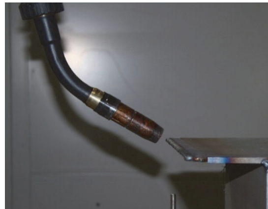
Abbildung 2: Horizontaler Überhang mit schräggestelltem Schweißbrenner /1/
