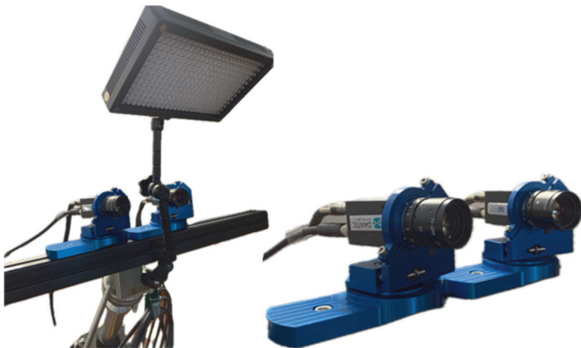
Abbildung 2: DIC Messaufbau mit Kameras, Stativ und LED-Beleuchtung
