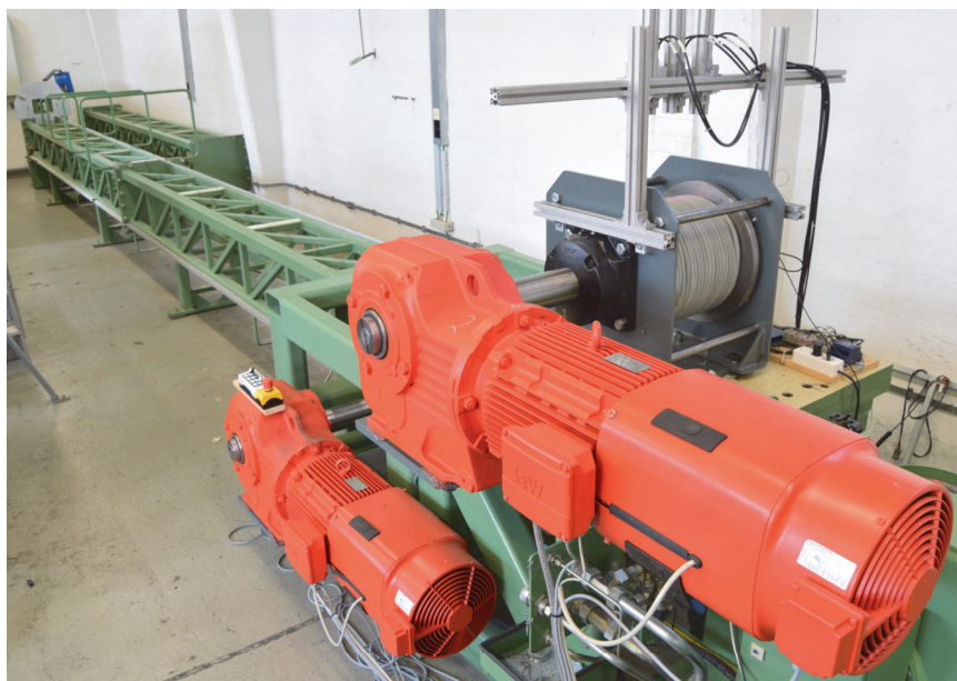
Abbildung 3: Der Spulprüfstand am Institut für Maschinenwesen, ausgestattet mit zwei elektrischen Antrieben für einen effizienten Dauerprüfbetrieb
