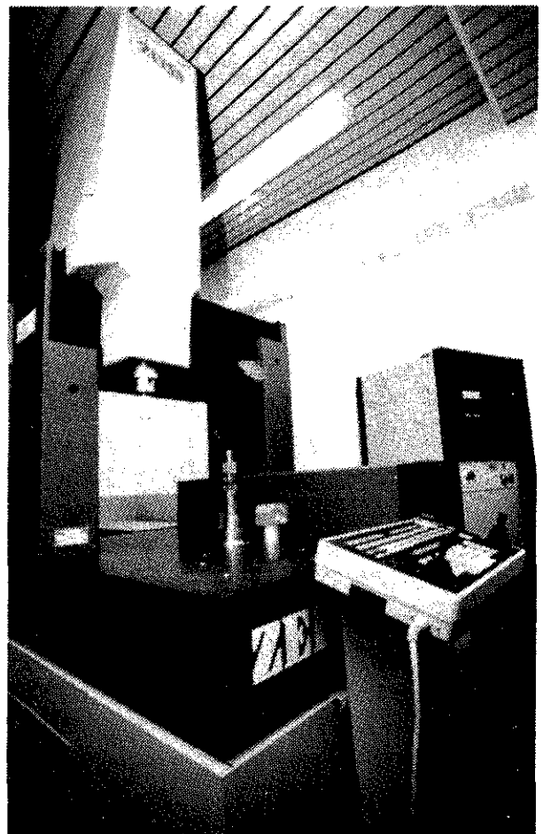
Bild 1: ZEISS-Koordinatenmeßmaschine UMM 550 mit Drehtisch, alphanumerischem Bedienpult und Steuerschrank
