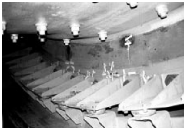
Bild 5: Ansicht des Mühlenkörpers von unten mit applizierter Meßtechnik
