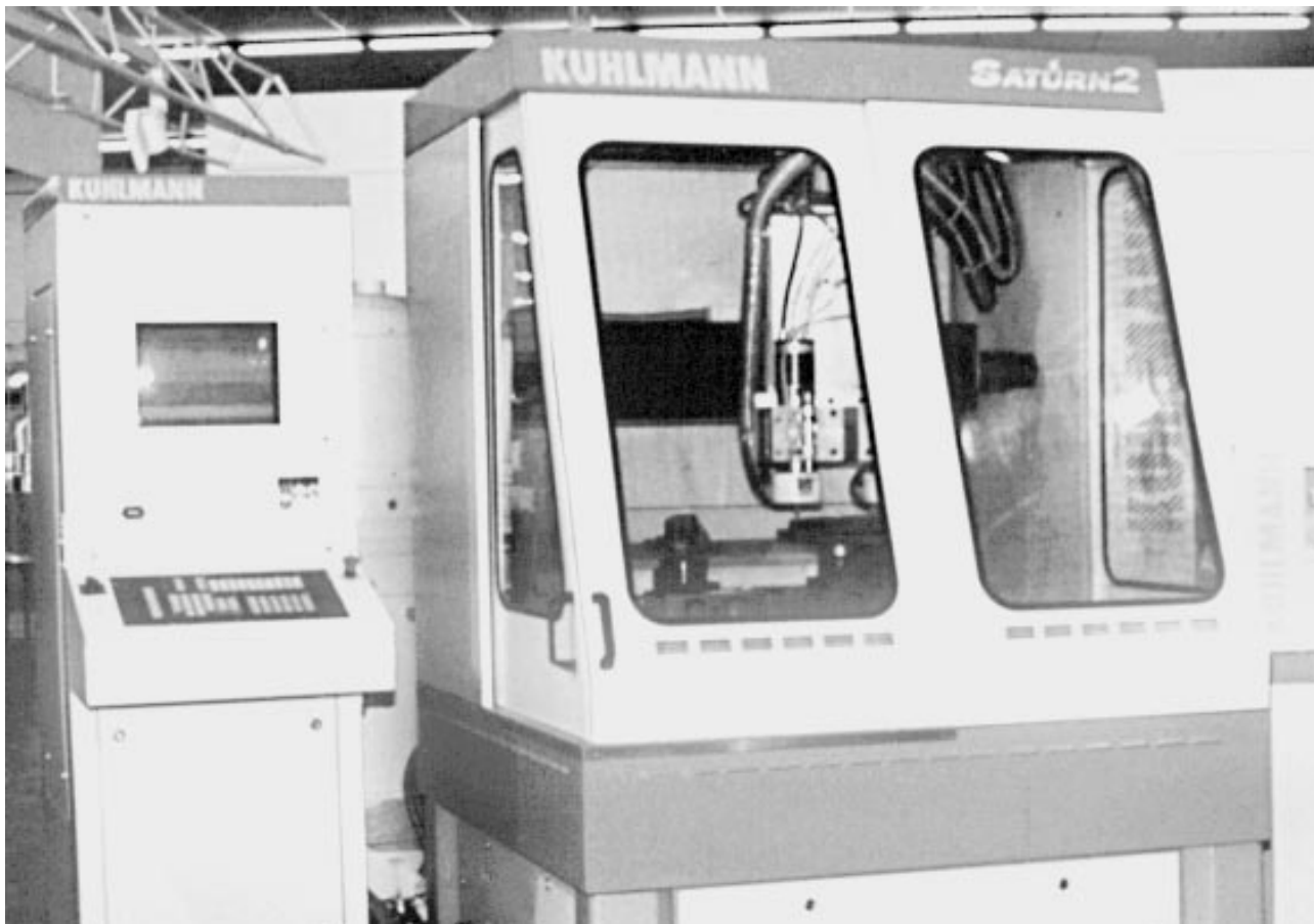
Bild 2: Realisierte Aabsaugungsanlage an einer Saturn 2
