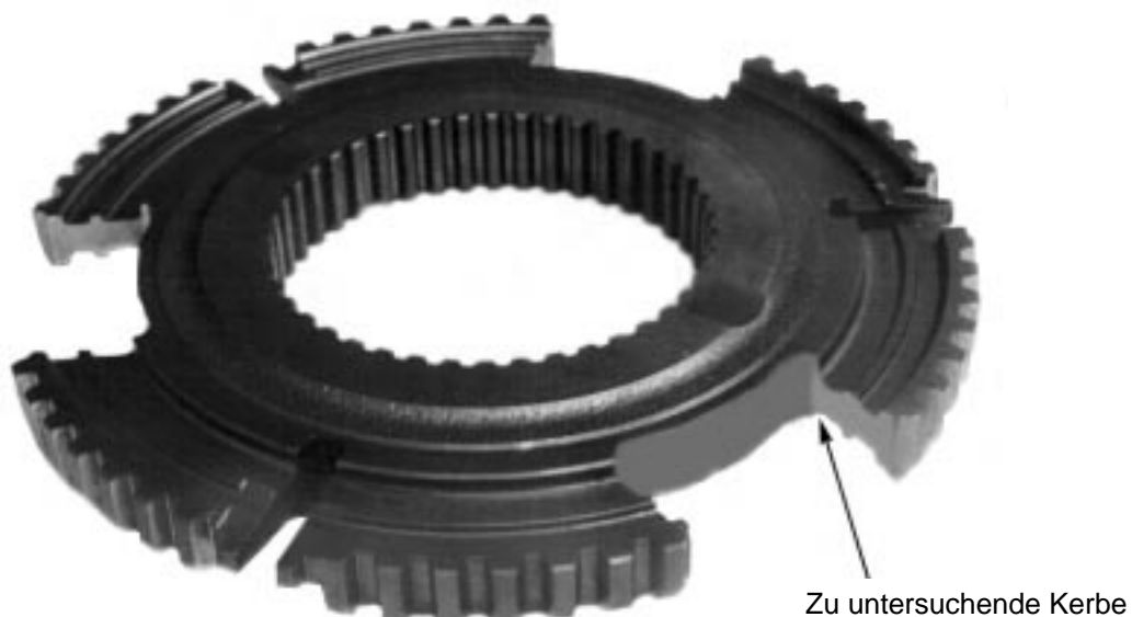
Bild 1: Foto des genuteten Zahnrades mit Kennzeichnung des zu untersuchenden Kerbbereichs (ZF-Friedrichshafen)
