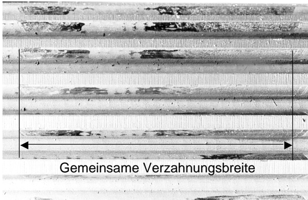
Bild 2: Flankenoberfläche in der Einlaufverschleißphase
