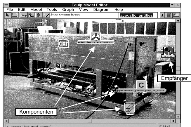
Bild 2 Erstellung eines Schallflußmodells
