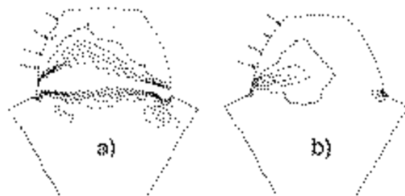
Bild 15: Ausbildung der plastischen Zonen eines überelastisch beanspruchten Wellenzahns bei gleicher Zahn-Normalkraft in Abhängigkeit von der Zahnform. Verzahnung nach DIN 5480, z = 6 . a) Profilverschiebung mit mittlerem Flankendruckwinkel \alpha = 24^\circ ; b) Profilverschiebung mit mittlerem Flankendruckwinkel \alpha = 27^\circ .
