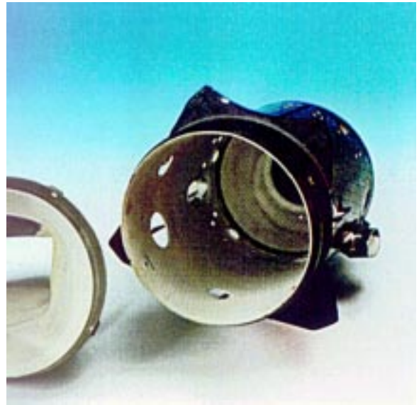
Bild 15: Mit Zirkoniumoxid beschichtete Brennkammer /5/
