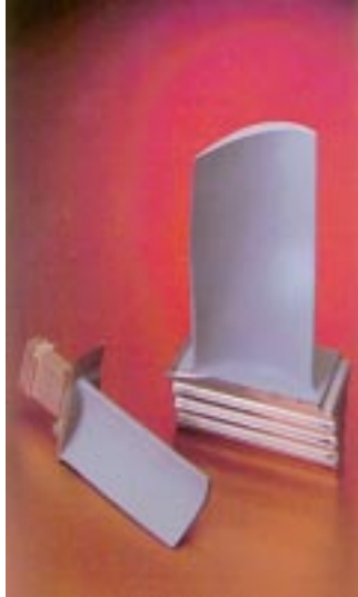
Bild 13: Heißgaskorrosions - Oxidationsschutzschicht, MCrAlY-Schicht /7/
