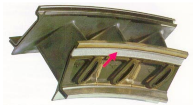
Bild 12: Verschleisschutzschicht aus Chromkarbid-Nickelaluminium an einer Turbinenleit-schaufel /7/
