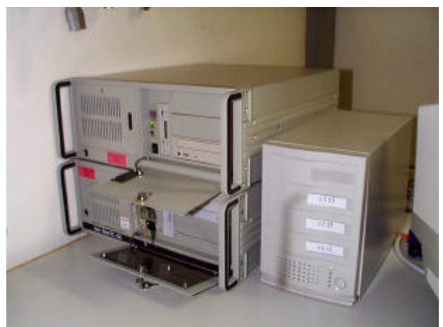
Bild 2: Oracle Server des IMW, rechts daneben: Externes SCSI Gehäuse mit drei weiteren Festplatten
