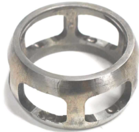
Bild 8: Kantenabbrüche am Käfig nach einer Lastwechselzahl von ca. 23 Mio.
