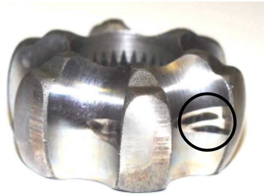
Bild 2: Kugelabdrücke in der Kugelnabe nach einer Lastwechselzahl von ca. 3 Mio.
