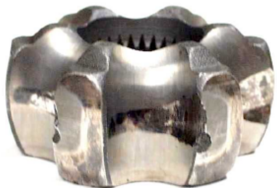
Bild 9: Kantenabbrüche in der Kugelnabe nach einer Lastwechselzahl von ca. 23 Mio.
