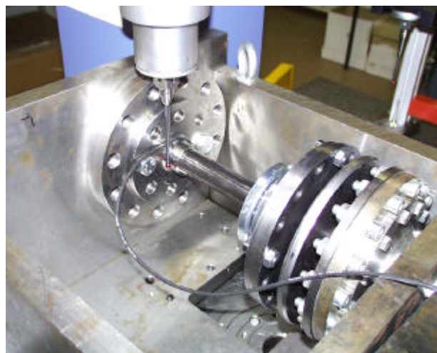
Bild 1: Versuchsaufbau zum Teil 1: Deformationsverhalten von Welle-Nabe-Verbindungen
