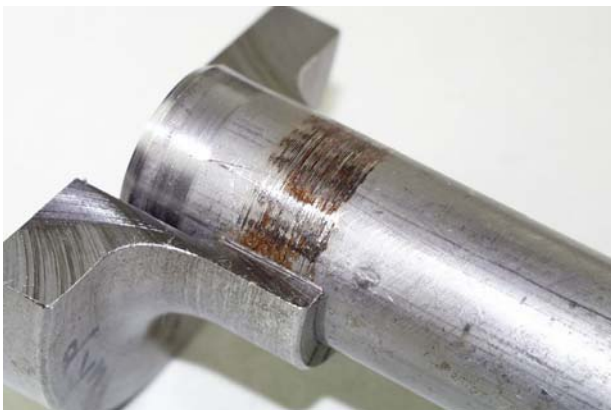
Bild 22: Reibkorrosionsspuren im Dauerschwingversuch bei: dyn. Lastziffer T dyn /T I1 = 2,35 (18,7 Mio. LW)
