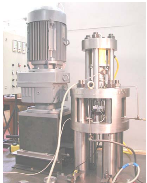
Bild 17: Gesamte Ansicht des Druckkammprüfstandes ohne Rechner
