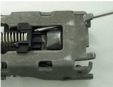
Bild 4: AB-Schloss (Takata) verriegelt mithilfe Stielkamm
