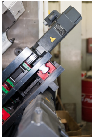
Abbildung 3: CAD (a) und fertige Konstruktion (b) von Kreuztisch
