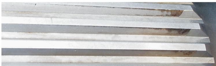
Bild 3: Kontaktdruckbereiche mit teilplastischen Zonen
