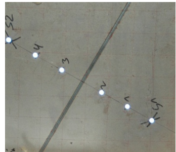
Abbildung 2: Lokal wärmebehandelte Zone auf einem Blech aus LH800®.
