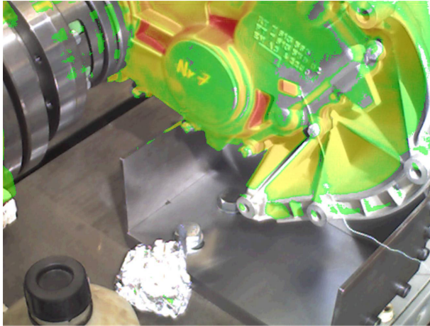
Abbildung 3: Temperaturanalyse eines Getriebehäuses
