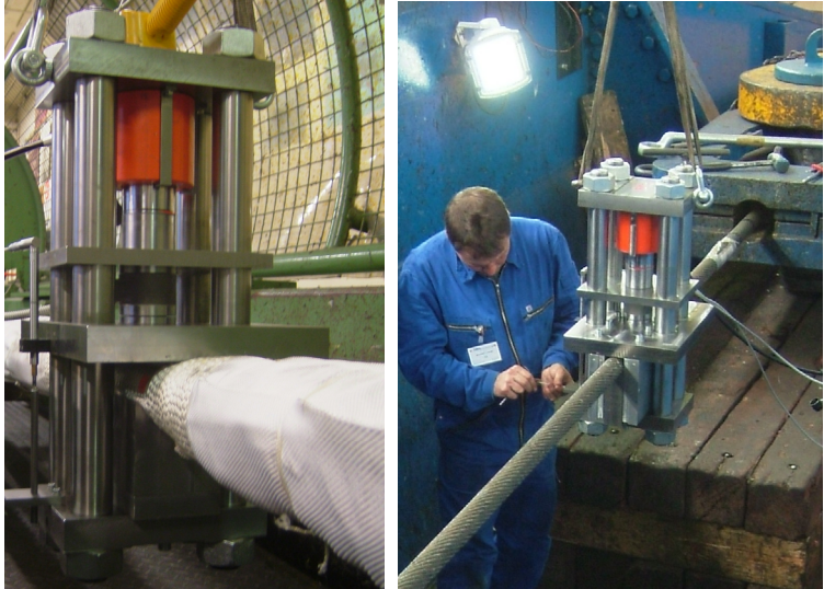
Abbildung 3: Mobiles Seilquerprüfgerät zur Bestimmung der Quere- lastizität von Seilen im Einsatz an Faser- (links) als auch Drahtseilen (rechts)
