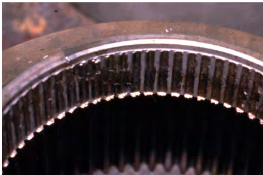
Abbildung 1: Verschleißschaden an einer Naben(Innen)verzahnung
