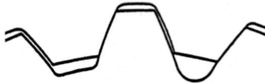
Abbildung 2: Die zwei Profile in ISO 4156 /2/, links: flat root, rechts: fillet root
