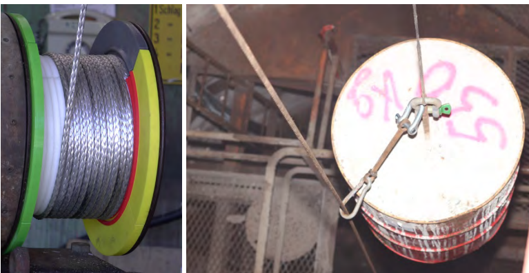
Abbildung 15: Seiltrommel mit faserseilspezifischen Anpassungen und Testgewicht im Schacht
