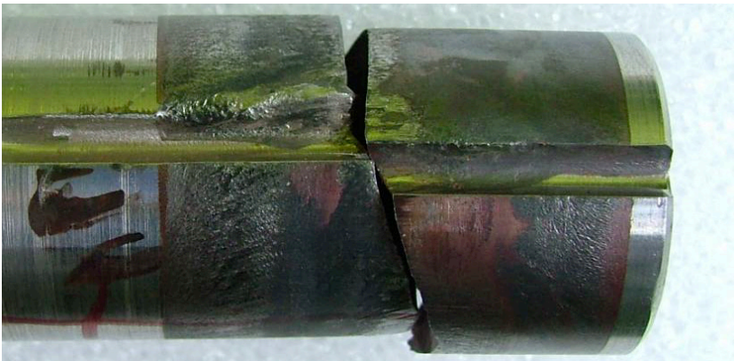
Abbildung 11: Wellenbruch 1_0,1875_0,5_1,4, kombinierte Belastung (stat. Torsion + Umlaufbiegung) /5/
