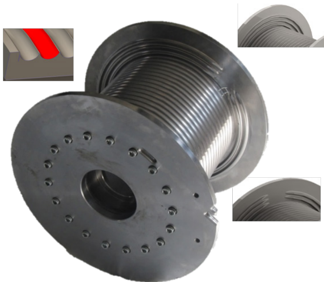
Abbildung 19: Seiltrommel mit angepasster Rillung und Auffüllgeometrien
