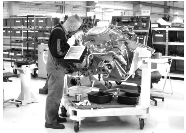
Bild 1: Instandsetzung eines Rotortriebes
