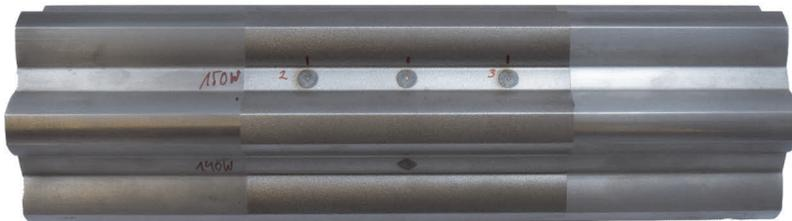
**Abbildung 1:** Zahnwelle mit eingebrachten Werkstoffsensoren für die Durchführung der Prüfstandsversuche /1/
