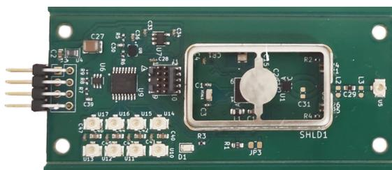
**Abbildung 2:** Platine mit Auswerteelektronik und Modul zur Datenübertragung
