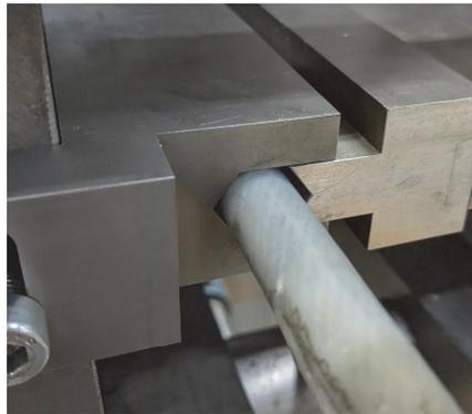
**Abbildung 3:** Technische Zeichnung und reale Ausführung der Querprüfbacken
